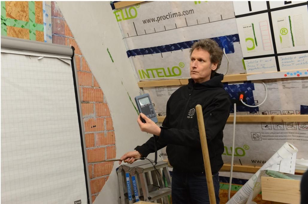
Abbildung 3: Leckagesuche im pro clima Schulungshaus in Schwetzingen. BlowerDoor-Messdienstleister stellen nicht nur die Luftwechselrate eines Gebäudes fest, sondern suchen auch die Stellen, aus denen die Luftundichtheiten sind, damit gefährliche Leckagen ausgebessert werden können.
