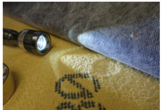
Die darunterliegende Holzfaserplatte hat nach Beschuss mit 50 mm Hagelkörnern eine ca. 4 mm tiefe Delle
