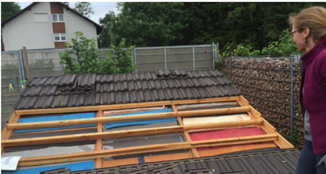
Untersuchung von frei gespannten Unterdachbahnen verschiedener Hersteller 5 Jahre nach dem Einbau
