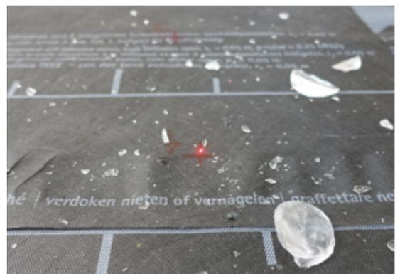
Die pro clima-Unterdachbahnen bleiben auch nach mehrfachem Beschuss mit den grösstmöglichen Hagelkörnern unbeschädigt
