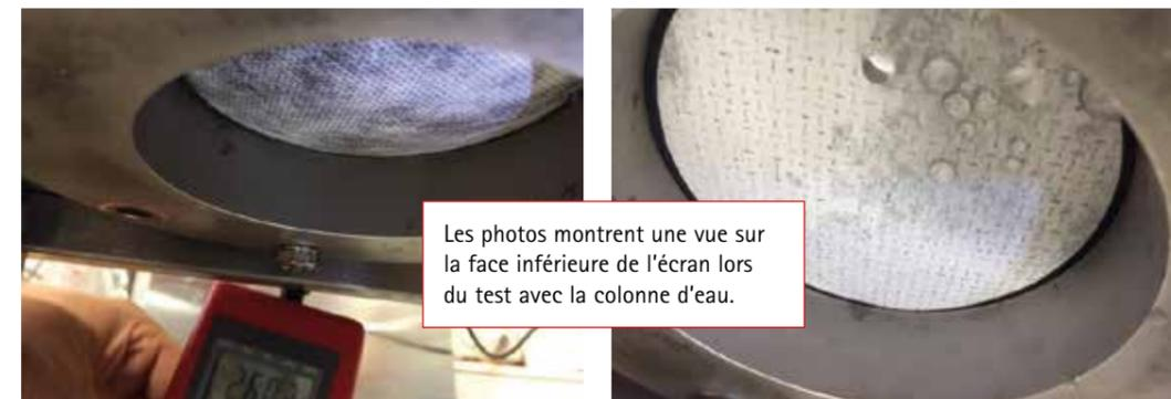
Les photos montrent une vue sur la face inférieure de l'écran lors du test avec la colonne d'eau.
