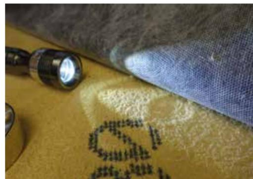
Après avoir subi la projection de grêlons de 50 mm de diamètre, le panneau en fibres de bois sous-jacent présente une déformation d'environ 4 mm.
