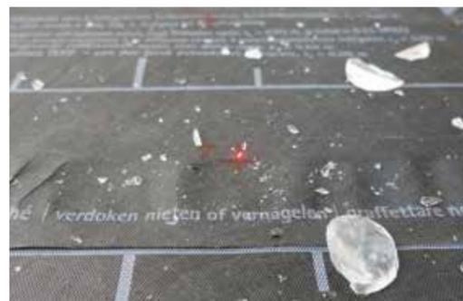
Les écrans de sous-toiture pro clima restent intacts, même après avoir subi la projection de grêlons au diamètre maximal.
