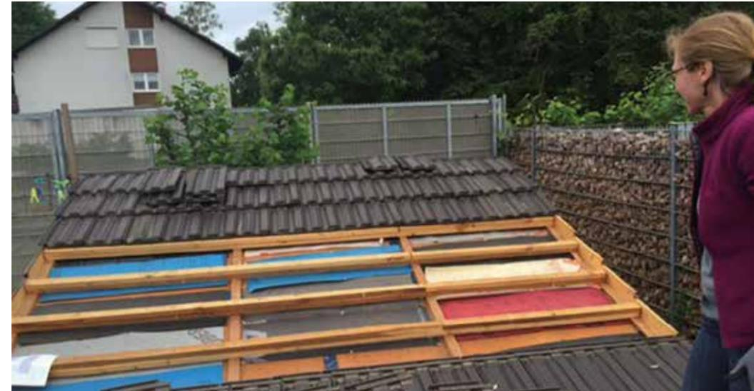
Analyse d'écrans de sous-toiture (pose libre tendue) de différents fabricants 5 ans après la mise en œuvre
